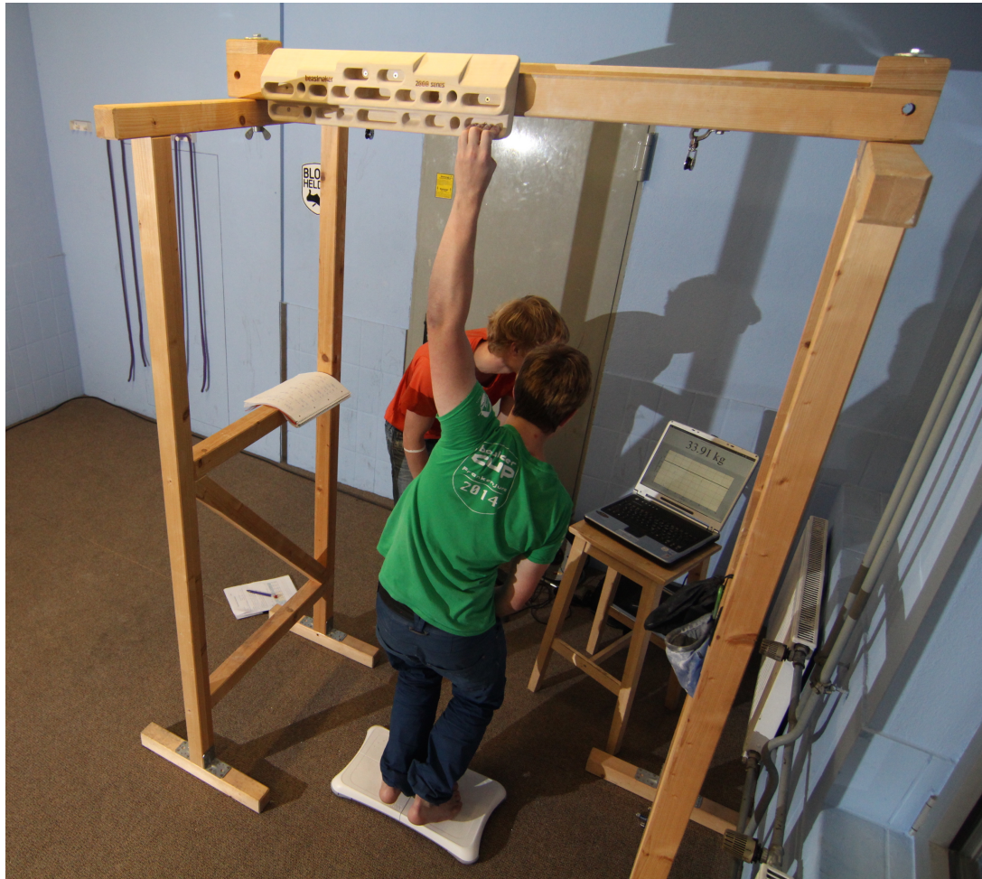
Abb.8: Aufbau des Messsystems
